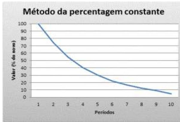
Em virtude do tipo de cálculo, extremamente repetitivo e com grande número de casas decimais, a aplicação deste método deve ser feita com o auxílio de computador. Os valores calculados por este método são boas aproximações da realidade do mercado quando comparados com aqueles obtidos por meio de pesquisas no mercado de máquinas e equipamentos usados.
